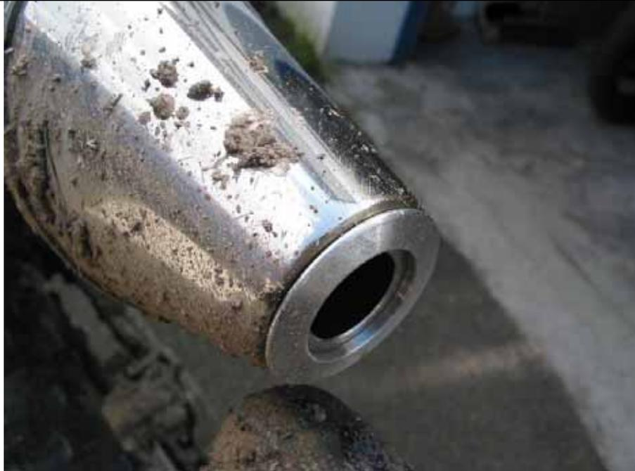
Jetzt mit einem wasserfesten Stift den eingesteckten DB-Eater von unten durch den Trichter und durch das Mündungsrohr markieren.
