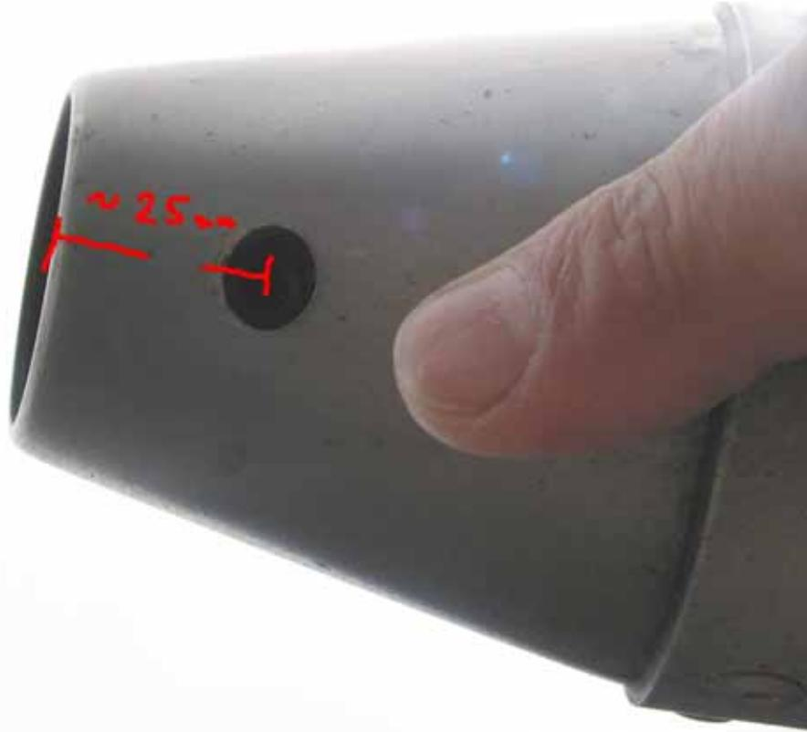
Jetzt ein 5,5 mm Loch von unten in das darunter liegende Mündungsrohr bohren. Das kleine Loch im Mündungsrohr sollte genau mittig zum großen Loch im Trichter sein, da die Befestigungsschraube dort hinein muß.
